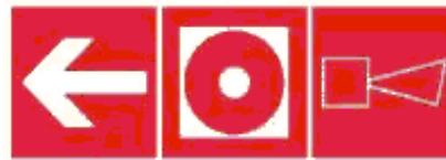
Кнопка включения установок пожарной автоматики и оповещателей налево
